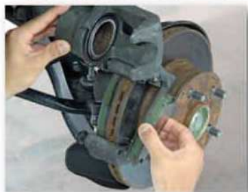
⑤制動装置 （ディスクキャリパ、ブレーキドラムの取り外し）
