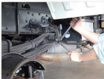
⑤制動装置 （ディスクキャリパ、ブレーキドラムの取り外し）
