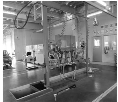
作業工具を集約したパネル
