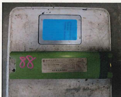
安定器本体の色が 緑色 (PCB不使用)
