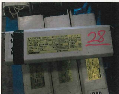
安定器本体の色が 白色 (PCB不使用)
